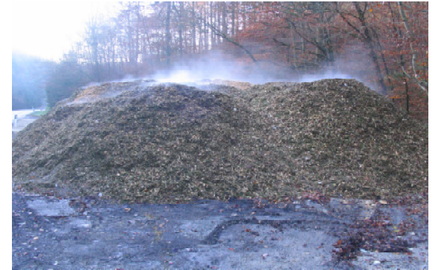
Lagerung mit hohem Energie- und Wertverlust: frische Hackschnitzel ohne Schutz vor Niederschlägen auf unbefestigten Boden
