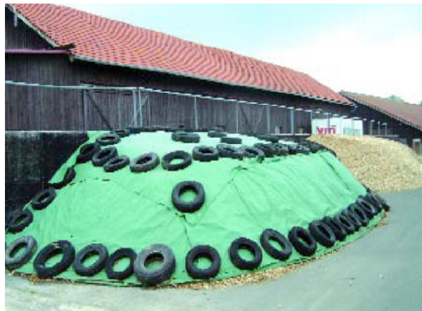
Lösung ohne Dach: Witterungsschutz für frische und trockene Hackschnitzel durch Spezialvlies
